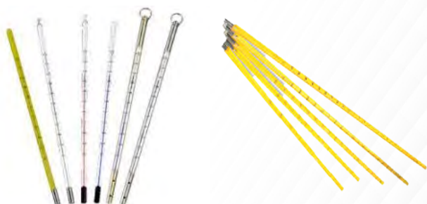
Termómetros de líquido en vidrio Alcance: -20\text{ }^{\circ}\text{C} a 120\text{ }^{\circ}\text{C}
