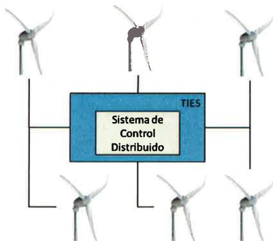
Figura 2 – Sistema de Control Distribuido de Aerogeneradores.
