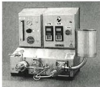
**Ilustración 1, espumadora continua escala laboratorio (solo como referencia)**
