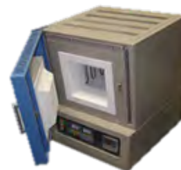
Horno de tratamientos térmicos
