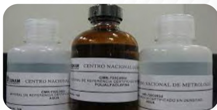
Calibración de Densímetros Digitales, en un intervalo de medida de: 794,54 \text{ kg/m}^3 a 998,20 \text{ kg/m}^3
