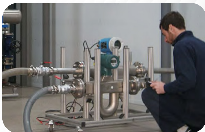
Calibración de Flujo Másico por comparación con medidor maestro, hasta 8 000 kg/min y flujo volumétrico hasta 8 000 L/min
